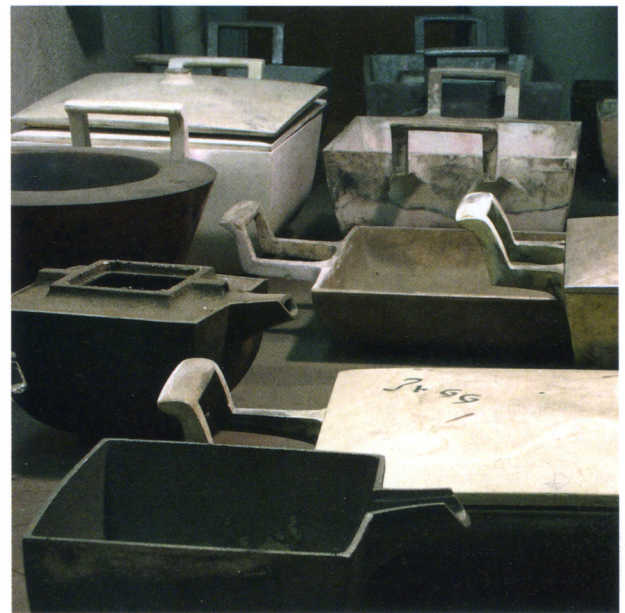
PFANNEN, TÖPFE, BRÄTER UND KANNEN werden in dem Nürnberger Atelier entwickelt und nach Hoffmanns Gussmodellen in Zusammenarbeit mit regionalen Eisengießereien gefertigt. Den Feinschliff bekommen die Gussrohlinge wieder in seiner Werkstatt.
